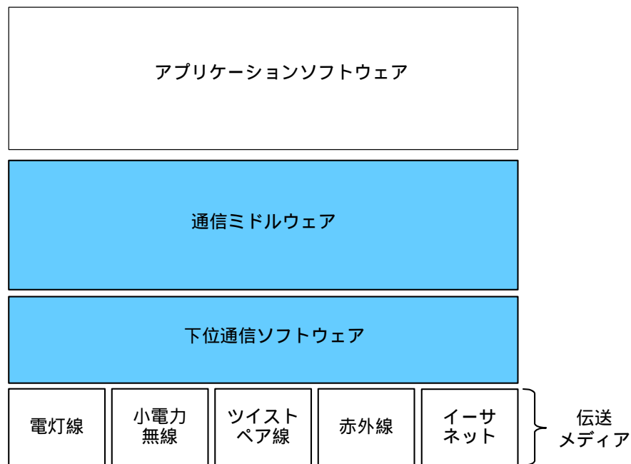
図3.1 ECHONETの通信レイヤ構成の概要
