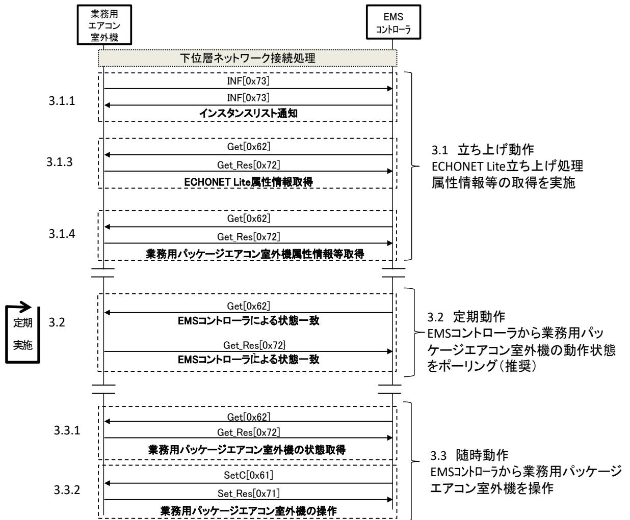
図 3-2 標準的な動作シーケンス例 (室外機)
