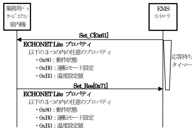
図 3-9 業務用パッケージエアコン室内機設定制御シーケンス
