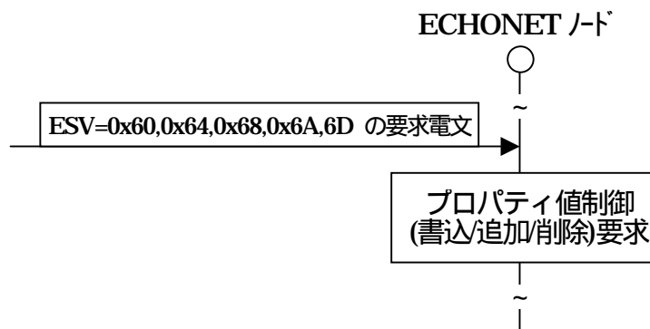
図5.4 ESV = 0x60,0x64,0x68,0x6A,0x6D、CpESV = 0x60 の要求受信時の基本シーケンス
