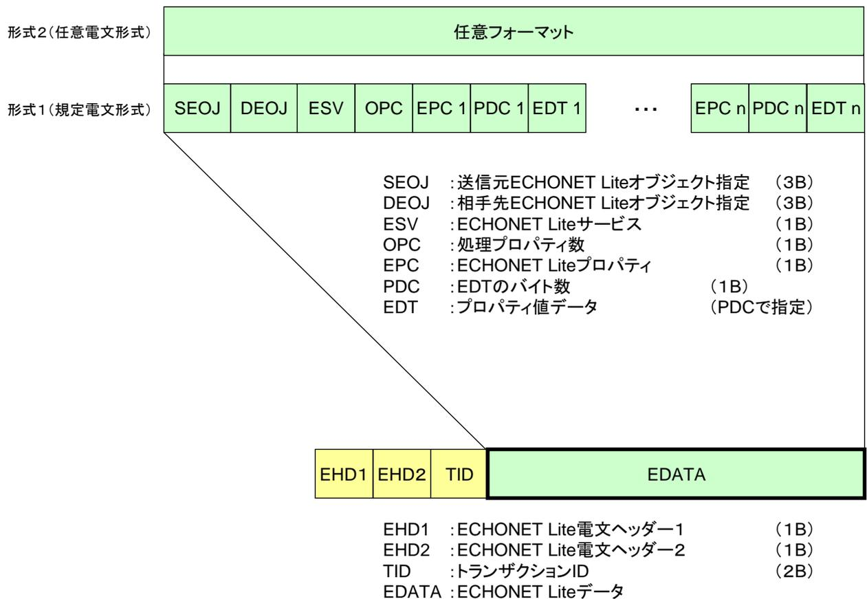
図 3-1 ECHONET Lite フレームの電文構成
