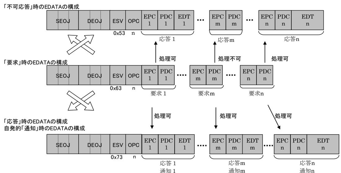
図 4-1 2 プロパティ値通知サービス時の EDATA の構成
