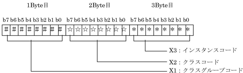
図 3-4 EOJ コードの詳細規定
