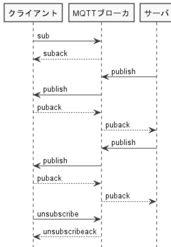
図 5-1 MQTT による INF 実現例
