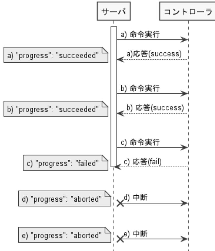
図 7-5 sequential モード : c) 実行後停止
